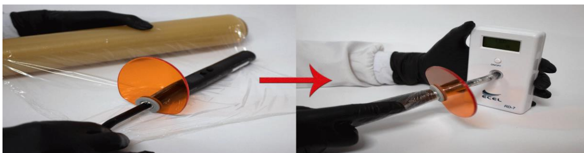
Figura 3 – Aferição da potência do fotopolimerizador envolvido com PVC
