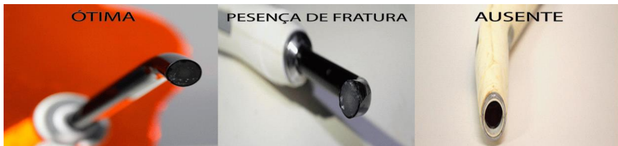
Figura 5 – Estado das ponteiras
